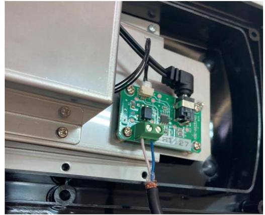
マイナスドライバーなどで端子台ネジを緩め、信号線を差し込む。
