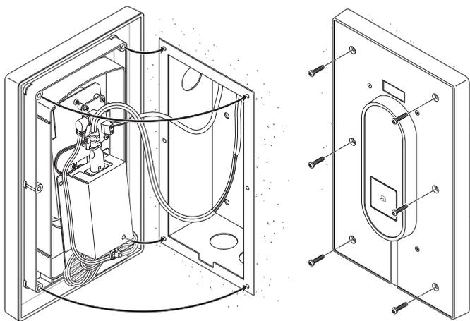
信号線、電源線を接続後、取付キットと取付ボックスのビス穴が合わさるように重ねる。次に、取付キット側から、ビスを6カ所締める。
