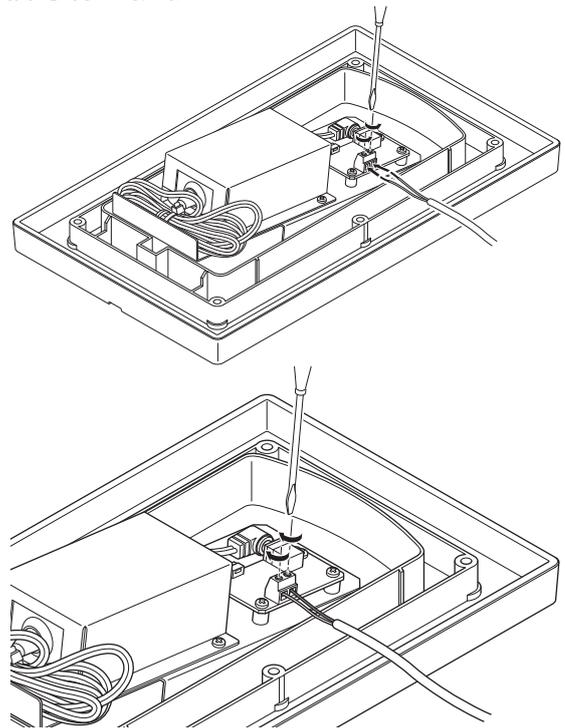
マイナスドライバーなどで端子台ネジを緩め、信号線を差し込む。
