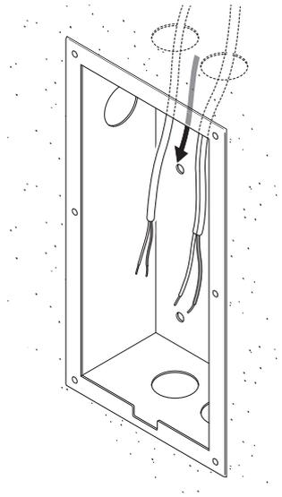
取付ボックスを埋め込み、ボックス内に信号線、電源線を引き込む。
