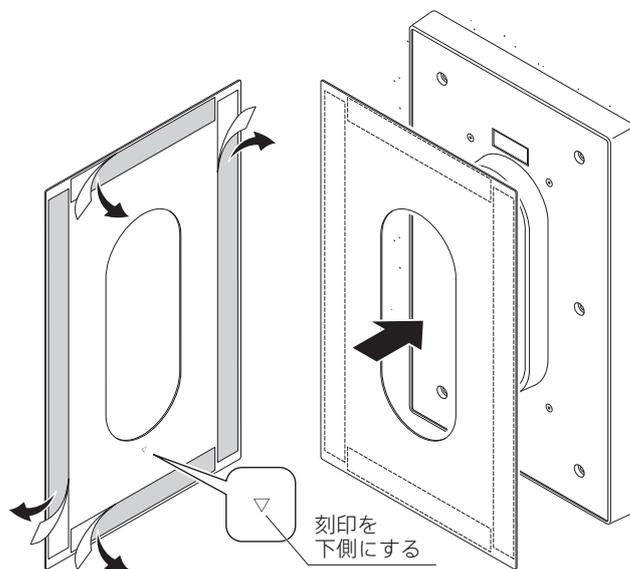
銘板の接着紙の剥離紙を4箇所剥がし、取付キットに取り付ける。
