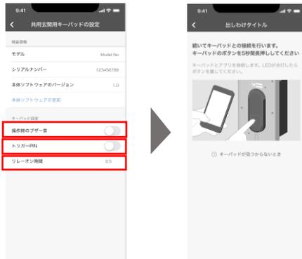
操作音のブザー音、トリガーPINのON/OFF、リレーオン時間の変更が可能
